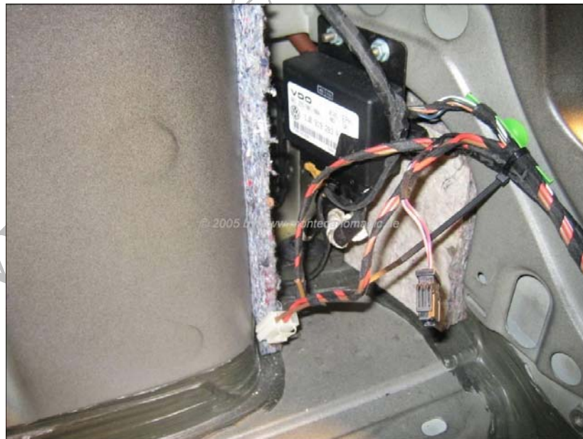
verbautes Steuergerät unter der rechten Rückleuchte
