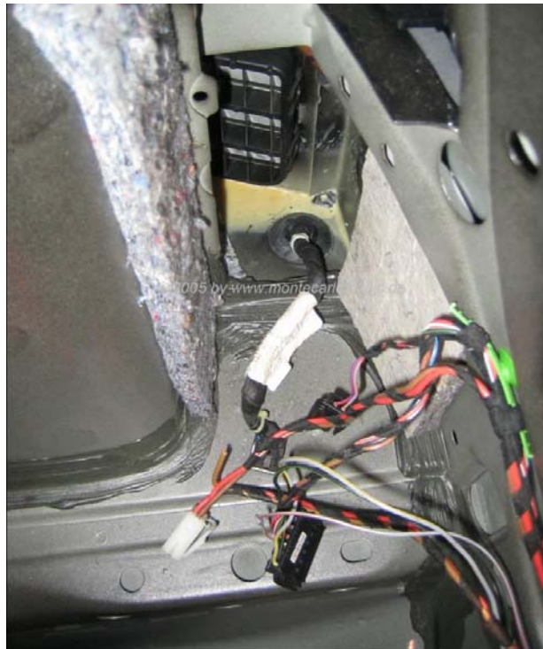
hier ist der bereits nach innen geführte Kabelsatz und die Strebe mit den beiden Löchern zu sehen
